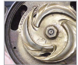
L'impulseur du concurrent est effectivement usée.
