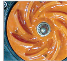
Tsurumi Impulseur poli, non usé par des matériaux abrasifs.
